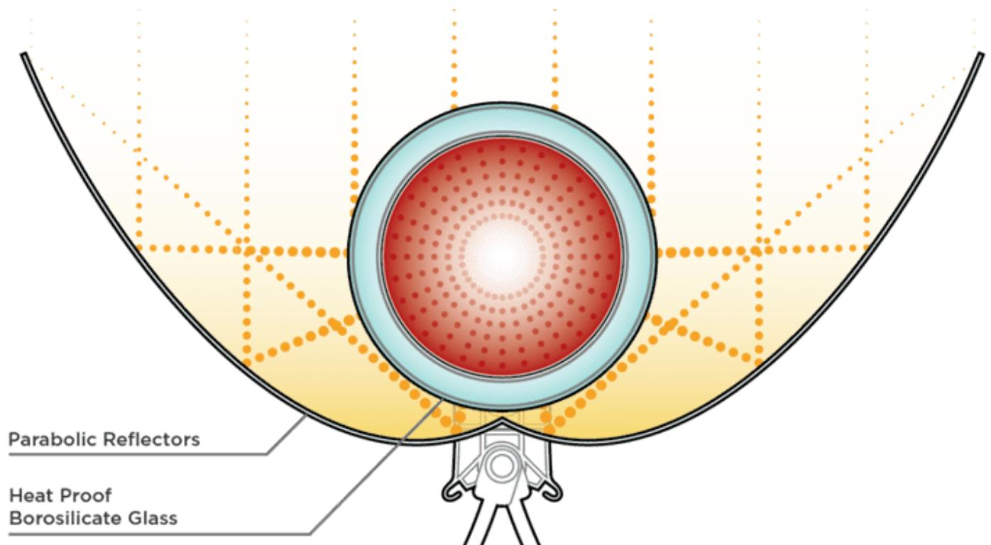
Ecco un miracolo della scienza, un tubo di vetro svuotato un isolante quasi perfetto, permette di cucinare con il sole anche nelle condizioni più difficili. Catturando efficacemente la luce da una vari angoli si può cuocere qualsiasi cosa con la luce del Sole.
