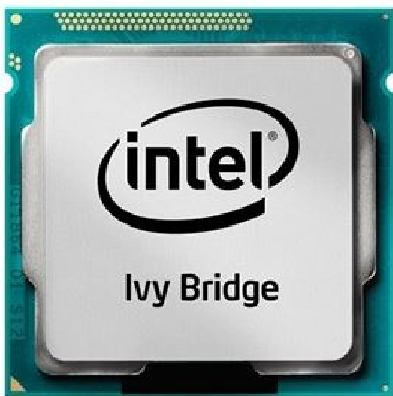
La settimana scorsa alcuni rumor sul [web](#) hanno rivelato che nel 2014 Intel, la famosa casa produttrice di CPU, aveva in mente di allontanare la tecnologia socket LGA per implementare quella del package BGA cioè la saldatura delle CPU su schede madri anche per sistemi [desktop](#).
